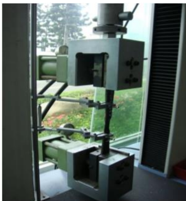
เครื่องมือดึงสายพานเพื่อหาค่า Tensile Strength
