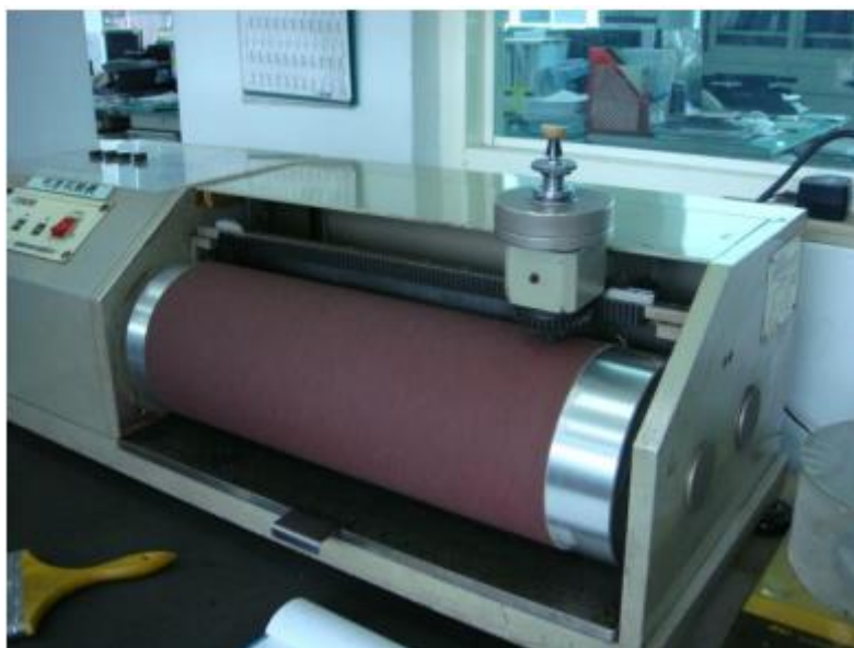
เครื่องมือวัด Wear loss (mm 3 ) ของยาง
