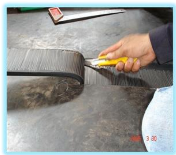
ผิวของสายพาน (Rubber Cover) แบบเรียบ
