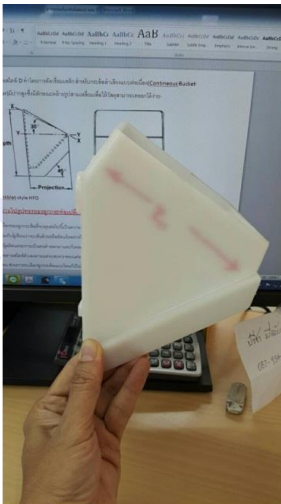
รูป 29 ลูกกระพ้อสไตล์ D ลดความสูงด้านหลังเพื่อให้ติดลูกกระพ้อ ให้ชิดกันมากยิ่งขึ้นเพื่อเพิ่ม Capacity
