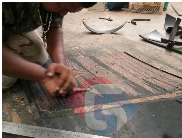
รูปที่ 8 การเปิดผ้าใบและลอกผ้าใบ
