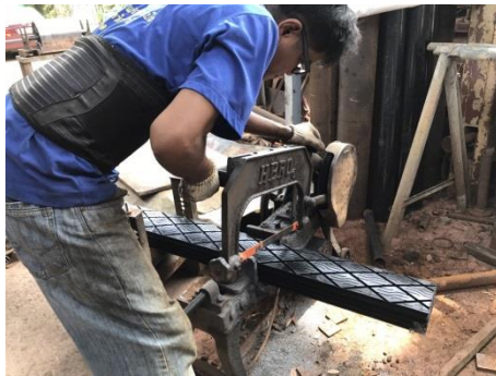
รูปแสดงการตัด Lagging Pad และ เหล็กยึด (Retainer)
