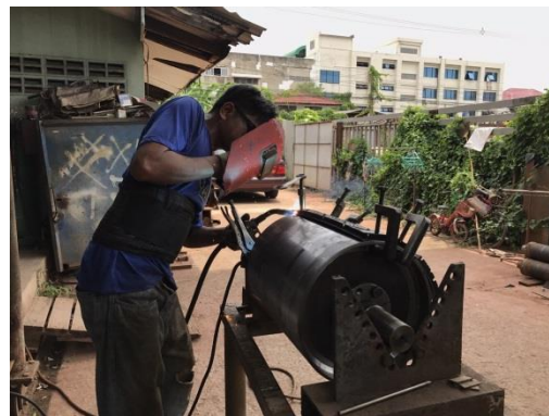
รูปแสดงการเชื่อมยึด Lagging pad เข้ากับฟูลย์
