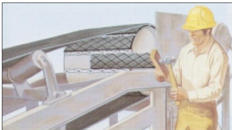
รูปแสดงการเปลี่ยน Lagging pad โดยการ slide แผ่นออก
