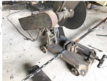
รูปแสดงการตัด Lagging Pad และ เหล็กยึด (Retainer)
