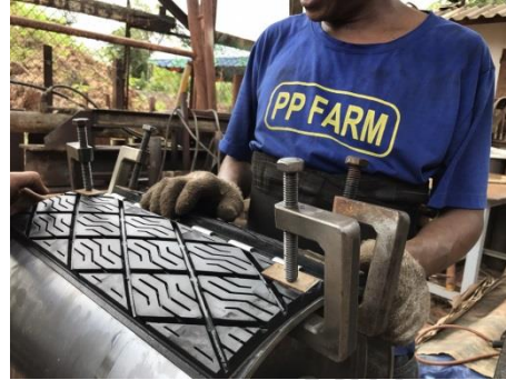
รูปแสดงการวางและล็อก Lagging pad และ Retainer ลงบนฟูลย์
