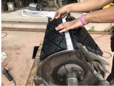
รูปแสดงการวางและล็อก Lagging pad และ Retainer ลงบนฟูลย์
