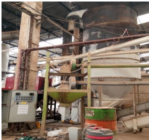
รูปที่ 1 ระบบลำเลียงถูกไฟไหม้
