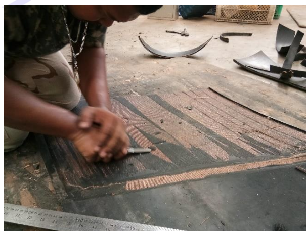
รูปที่ 8 การเปิดผ้าใบและลอกชั้นผ้าใบ
