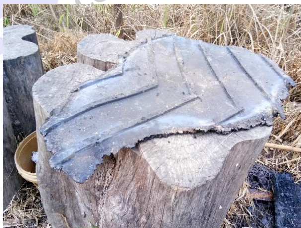
รูปที่ 2 สายพานที่ถูกไฟไหม้
