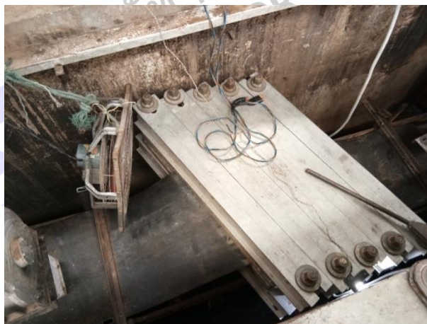
รูปที่ 12 ประกอบเตาต่อสายพานและอบสายพาน
