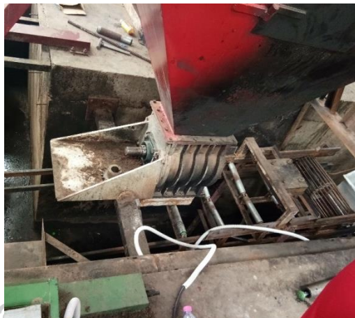
รูปที่ 1 ระบบลำเลียงถูกไฟไหม้
