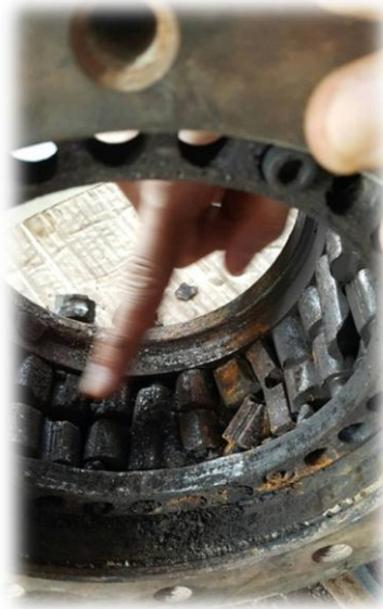
รูปตัวอย่าง Back Stop ที่เสียหายเนื่องจากไม่ได้เติมจาระบีอย่างสม่ำเสมอ
