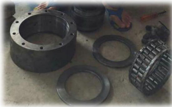
รูป Back Stop เสียหายจากการใช้ค้อนอัด
